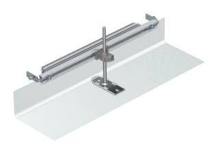
Montagefertiger Kanalendverschluss, bestehend aus einer flexiblen Schürze mit Seiten- und Bodenbelaganlegeprofilen. Im Lieferumfang enthalten sind Kanalverbindungswinkel und ein höhennivellierbarer Befestigungswinkel.
