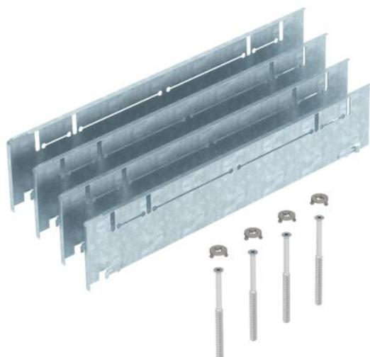
Höhenausgleich-Bausatz für Unterflurdosen UZD350-3 und UGD350-3 mit einer Bauhöhe von 70 bis 125 mm für die bauseitige Erhöhung der UZD/UGD auf eine Höhe von 115-170 mm, bestehend aus 4 Fallblechen, 4 Nivellierschrauben und 4 Drehverschlüssen.
