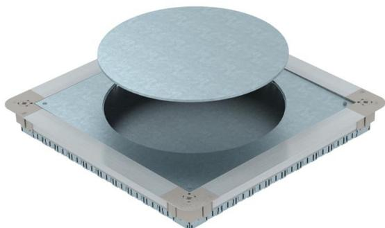
Unterflur-Gerätedose mit Montagedeckel und Deckelblindplatte mit Seitenwänden aus Stahlblech. Für den Einbau eines quadratischen Geräteeinsatzes GES9 55 in Estrichhöhen ab 55 mm. Lässt sich stufenlos auf Estrichnennhöhe nivellieren und der Estrich kann bündig an die Estrichabzugskante angearbeitet werden. Mit Rohreinführungsöffnungen je Seite 7 x M20, 3 x M25, 4 x M32. Nutzbare Rohrgröße bei einer Systemhöhe von 55 mm: M20.
