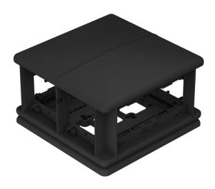
Fußbodenüberragende Einbaueinheit für den Einbau von 8 einzelnen Installationsgeräten mit Tragering oder -bügel auf 4 Seiten. Die Trennung der Stromarten (4 + 4) erfolgt mittels einer Trennwand. Bei Verwendung von Mehrfach-Installationsgeräten kann die Anschlusskapazität erhöht werden. Schraubbefestigungsspur für Installationsgeräte: 60 mm senkrecht.
