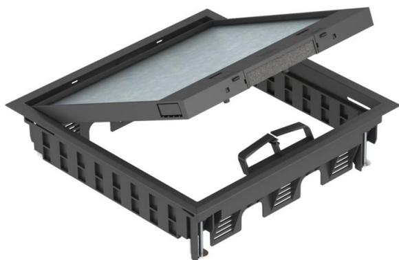
Geräteinsatz mit Rastschieber für bis zu 12 Modul 45-Einzelgeräte in 3 Universalträgern UT4, Einsatz in Kanalsystemen und Systemböden im Innenbereich. Bodenbelagausparung im Klappdeckel voreingestellt auf 5 mm, bei Bedarf auch einstellbar auf 10 mm.
