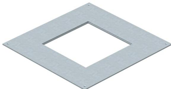
Montagedeckel für Unterflur-Zug- und Abzweigdosen vom Typ UZD350-3 und UZD350-4 zum Einbau oder Aufbau einer Einbaueinheit. Einbauöffnung 3 mm vertieft zum nachträglichen Blindverschluss mit Deckelblindplatte.
