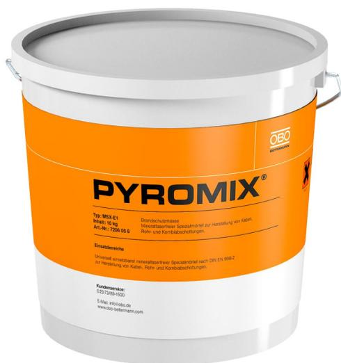
Mörtel zum Erstellen von Kabel- und Kombiabschottungen in massiven Wänden und Decken. Geeignet zum Pumpen, Pressen und zum Handeinbau. 10 kg Trockenmörtel ergeben bei Zugabe von ca. 3 Litern Wasser etwa 10 Liter verarbeitungsfähige Masse. Anwendung im Innenbereich.
