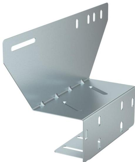
Universelle Montageplatte zur Befestigung der FireBox T-Serie an der Vorderseite von Kabel- und Gitterrinnen sowie Kabelleitern mit max. 60 mm Seitenhöhe. Ermöglicht die sichere Montage der Funktionserhaltkabel, ohne diese über den Seitenholm biegen zu müssen. Passend für alle FireBoxen.
