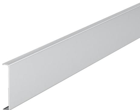
Oberteil aus Aluminium zum Verschließen der Rapid GA Geräteeinbaukanäle und ISS Installationssäulen mit 76,5er Systemöffnung. Der feste Sitz des Oberteils und die elektrische Kontaktierung zum Kanal-/Säulenunterteil ist durch die Rastklammern Typ RKV3V garantiert. In jeder Lieferlänge (2000mm) sind 6 Rastklammern vormontiert.
