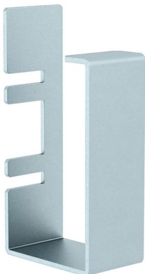
Kanalklammer für den Leitungsführungskanal Metall Typ LKM 60100, verhindert das Herausfallen der Kabel und Leitungen während der Installation. Die Kanalklammer ist zwingend erforderlich, wenn der Kanal in Kabel- und Leitungsanlagen mit integriertem Funktionserhalt nach DIN 4102 Teil 12 eingesetzt wird. Einfache Montage durch Einschieben in die Schlaufenlochung und Verrastung an der Seitenwand.
