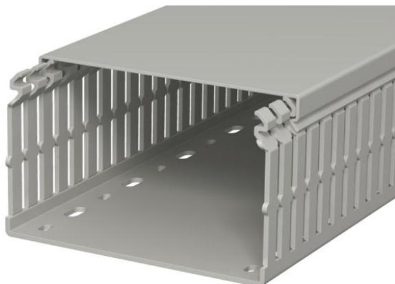
Verdrahtungskanal nach DIN EN 50085-2-3 inkl. Oberteil und Bodenlochung zur waagerechten und senkrechten Verlegung elektrischer Kabel und Leitungen im Schaltschrank. Ausführung als DIN-Kanal. Das Ausbrechen der Stege erfolgt werkzeuglos. Bodenbündiges Ausführen ist durch Sollbruchstellen möglich. Verjüngungen in den Seitenschlitz verhindern das Herausfallen der Leitungen. Geprüft nach DIN EN 50085-2-3. Sonderlängen auf Anfrage.
