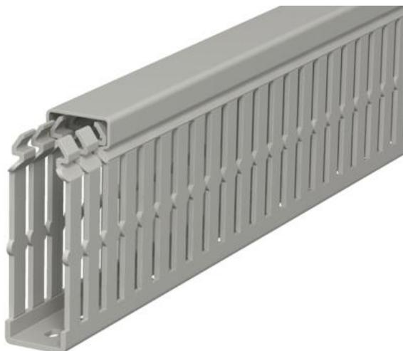
Verdrahtungskanal nach DIN EN 50085-2-3 inkl. Oberteil und Bodenlochung zur waagerechten und senkrechten Verlegung elektrischer Kabel und Leitungen im Schaltschrank. Ausführung als DIN-Kanal. Das Ausbrechen der Stege erfolgt werkzeuglos. Bodenbündiges Ausführen ist durch Sollbruchstellen möglich. Verjüngungen in den Seitenschlitz verhindern das Herausfallen der Leitungen. Geprüft nach DIN EN 50085-2-3. Sonderlängen auf Anfrage.
