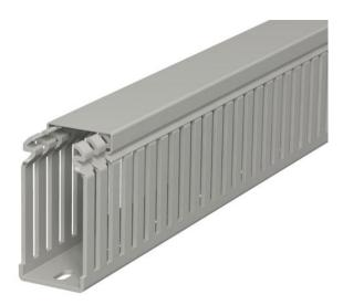
Verdrahtungskanal nach DIN EN 50085-2-3 inkl. Oberteil und Bodenlochung zur waagerechten und senkrechten Verlegung elektrischer Kabel und Leitungen im Schaltschrank. Ausführung als DIN-Kanal. Das Ausbrechen der Stege erfolgt werkzeuglos. Bodenbündiges Ausführen ist durch Sollbruchstellen möglich. Geprüft nach DIN EN 50085-2-3. Sonderlängen auf Anfrage.
