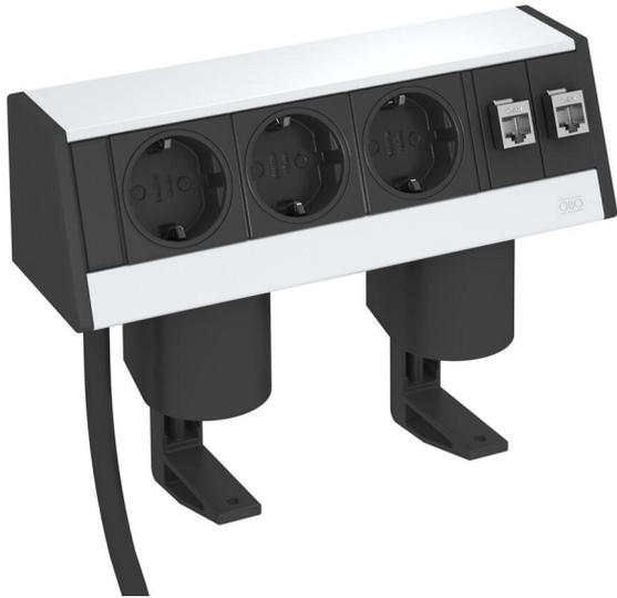
Deskbox mit Anschlusskabel, Kabelausschuss von unten aus dem Profil, mit zwei Befestigungszwingen für Tischplattenstärken von 8 bis 40 mm. Bestückung: - drei schwarze Schutzkontakt-Steckdosen in 0°-Steckrichtung, inkl. 3,0 m Netzkabel mit Winkelstecker CEE 7/7. - zwei Datentechnik-Kupplungen RJ45 auf RJ45, 1:1 verschaltet, Kat.6 geschirmt.
