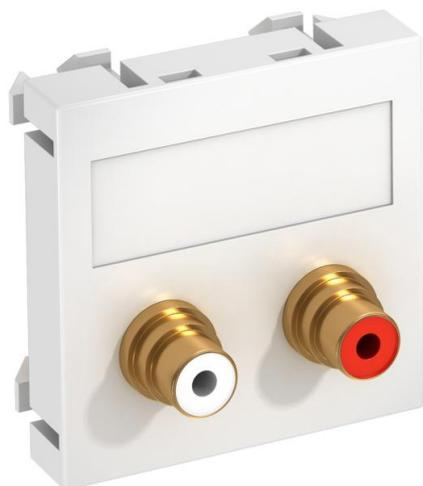
Multimediaträger mit zwei Cinch-Anschlussbuchsen für Audio R/L, Kabelausschluss gerade, mit Beschriftungsfeld, zwei Cinch-Kupplungen (RCA) in Ausführung Buchse-Buchse, Farbkodierung rot/weiß. Trägerplatte mit Rastbefestigung, geeignet für den waagerechten und senkrechten Einbau in die Systemumgebung.
