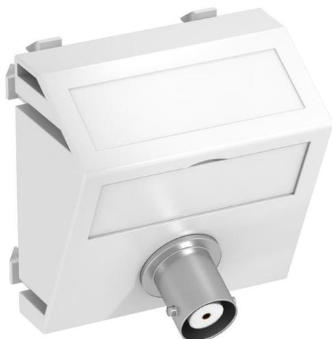
Multimediaträger mit einer BNC-Anschlussbuchse, Kabelauslass schräg, mit Beschriftungsfeld, BNC-Kupplung in Ausführung Buchse-Buchse. Trägerplatte mit Rastbefestigung, geeignet für den waagerechten und senkrechten Einbau in die Systemumgebung.
