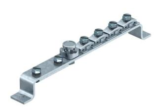
• Bügel und Überleger aus Stahl, galvanisch verzinkt • Klemmkörper und Kontaktleiste aus Messing, Schrauben aus Stahl, feuerverzinkt Anschlussmöglichkeiten: • 8 Leitungen bis 25 mm² • 1 Rundleiter Rd 8-10 • 1 Flachleiter bis FL 40
