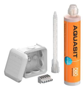
Kabelabzweigkasten-Set mit Klemmleiste zum Verbinden von Kabeln und Leitungen im Innenbereich und geschützten Außenbereichen. Inklusive Aquasit Kaltvergussmasse, Schutzart IP 68. Quadratische Form mit Einsteckdichtungen an den Seiten und Ausschlageinführungen im Boden. Geeignet für die Wand-/ Deckenmontage und die Montage auf Montageblechen. Mit der Möglichkeit zur Innenbefestigung. Mit festsitzendem Klemmdeckel. Hergestellt aus halogenfreien Materialien.
