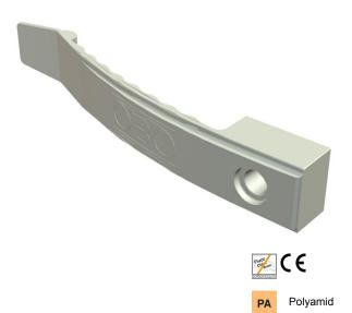
Standardausführung für allgemeine Anwendung, wie z. B. Zwischendecken und Zwischenden Installation. Klemmhöhe 9 mm - mit Distanzstück 13 mm. Befestigungsloch 6 mm Ø. 2032 für max. 8 Leitungen NYM 3 x 1,5 mm $^{\rm 2}$
