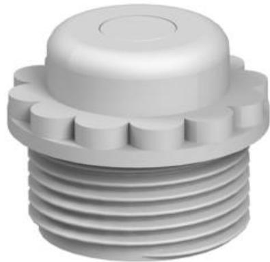
Mit Durchstoßmembrane, hierbei ist die Öffnung D vorgeprägt, aber zunächst verschlossen. Würgedichtung zum Einschrauben in metrische Gewinde nach IEC 423. Mit selbstdichtendem Konus am Gewindeende, daher kein Anschlussgewindedichtring erforderlich. Erreichbare Schutzart bei sorgfältiger Montage IP54.
