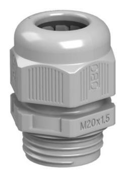
Kabelverschraubung mit metrischem Anschlussgewinde in Hutmutterbauart, für Kabelabzweigkästen, Gehäuse, Verteilerkästen im privaten und industriellen Bereich. Mit Zugentlastung und integrierter Dichtlippe, geprüft nach DIN EN 62444. Schutzklasse IP68. Einsetzbar von -20°C bis +65°C.
