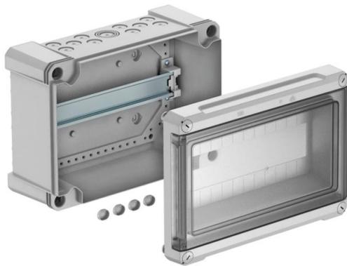
Kleinverteiler zur Aufputz-Montage, für die Strom-Unterverteilung im Innen- und Außenbereich, gemäß IEC 439-3. Mit vormontierter 35-mm-Hutprofilschiene. Schutzart IP66 und Schutzgrad IK06. Transparenter Deckel zum Schrauben, mit Ausschnitt. Inklusive 4 Schraubenabdeckkappen.
