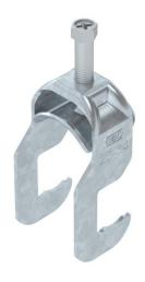
Bügelschelle mit RS-Fuß, Metalldruckwanne mit gerundeten Kanten für Kabelschutz. Zur vertikalen und horizontalen Montage von 1 Einzelkabel an Rundprofilen oder Rohren. Mit 1-gängiger Schraube an Druckwanne, universeller Sechskant-Schraubenkopf SW10, mit Schlitz und Kreuzschlitz. Passend zu allen Rundprofileisen bzw. Rohren mit Durchmesser bis 22 mm. Geeignet für Montage im Innen-und Außenbereich. Der Einsatz einer Gegenwanne wird empfohlen.
