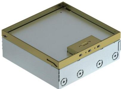
Quadratischer Bodentank für den Einsatz in trocken gepflegten Hohlböden und Estrichböden im Innenbereich. Einbaugehäuse mit vorgeprägten Einführungsöffnungen für Rohre (M25). Mit 3 Universalträgern UT4 und zwei 2-fach Steckdosen. Oberteil durch 4 Nivellierstützen auf Oberkante Bodenbelag einstellbar. Die Mindesteinbautiefe beträgt 95 mm, der Nivellierbereich + 30 mm.
