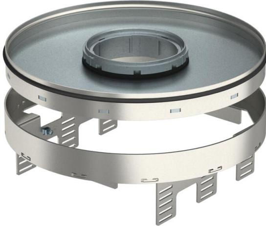
Nivellierbare und vom Fußboden entkoppelte Kassette der Nenngröße R9 für Tubus für den Einbau von Installationsgeräten in trocken oder nass gepflegten Fußböden im Innenbereich, zur Montage in Unterflurdosen UZD350-3 in Verbindung mit einem Montagedeckel DUG350-3R9 oder in UGD350-3R9. Die Montage erfolgt mittels Nivellierwinkeln (separat bestellen) im Aluminium-Rahmenprofil der Unterflurdosen.
