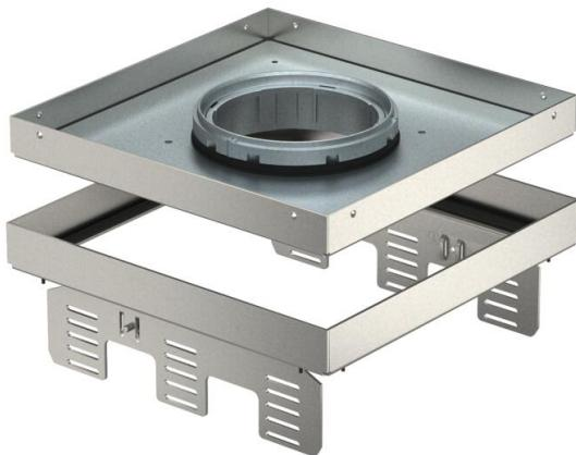
Nivellierbare und vom Fußboden entkoppelte Kassette der Nenngröße 9, für Tubus, für den Einbau von Installationsgeräten in trocken oder nass gepflegten Fußböden im Innenbereich, zur Montage in Unterflurdosen UZD250 oder UZD350, jeweils in Verbindung mit einem Montagedeckel DUG../9 oder in UGD250-3/9 oder UGD350-3/9. Die Montage erfolgt mittels Nivellierwinkeln (separat bestellen) im Aluminium-Rahmenprofil der Unterflurdosen.
