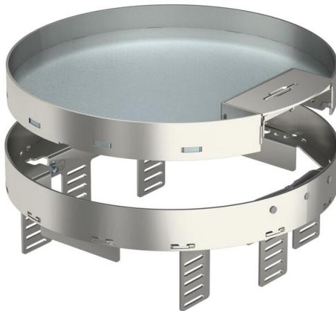
Nivellierbare und vom Fußboden entkoppelte Kassette der Nenngröße R7 mit Schnurauslass für den Einbau von Installationsgeräten in trocken gepflegten Fußböden im Innenbereich, zur Montage in Unterflurdosens UZD350-3 in Verbindung mit einem Montagedeckel DUG350-3R7 oder in UGD350-3R7. Die Montage erfolgt mittels Nivellierwinkeln (separat bestellen) im Aluminium-Rahmenprofil der Unterflurdosens.
