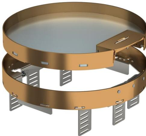
Nivellierbare und vom Fußboden entkoppelte Kassette der Nenngröße R7 mit Schnurauslass, für den Einbau von Installationsgeräten in trocken gepflegten Fußböden im Innenbereich, zur Montage in Unterflurtdosen UZD350-3 in Verbindung mit einem Montagedeckel DUG350-3R7 oder in UGD350-3R7. Die Montage erfolgt mittels Nivellierwinkeln (separat bestellen) im Aluminium-Rahmenprofil der Unterflurtdosen.
