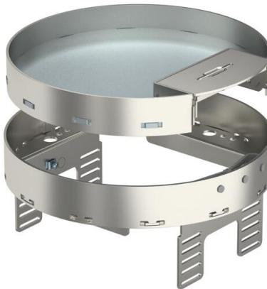
Nivellierbare und vom Fußboden entkoppelte Kassette der Nenngröße R4 mit Schnurauslass, für den Einbau von Installationsgeräten in trocken gepflegten Fußböden im Innenbereich, zur Montage in Unterflurdosen UZD250-3 oder UZD350-3, jeweils in Verbindung mit einem Montagedeckel DUG..R4 oder in UGD250-3R4 oder UGD350-3R4. Die Montage erfolgt mittels Nivellierwinkeln (separat bestellen) im Aluminium-Rahmenprofil der Unterflurdosen.
