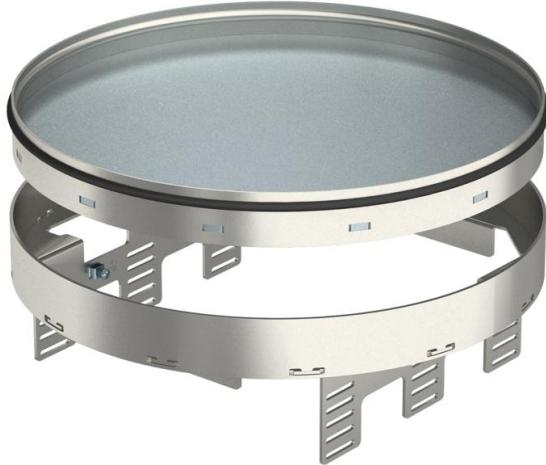
Nivellierbare und vom Fußboden entkoppelte Kassette "blind" für die Herstellung einer Revisionsöffnung der Nenngröße R9 in trocken oder nass gepflegten Fußböden im Innenbereich, zur Montage in Unterflurtdosen UZD350-3 in Verbindung mit einem Montagedeckel DUG350-3R9 oder in UGD350-3R9. Die Montage erfolgt mittels Nivellierwinkel (separat bestellen) im Aluminium-Rahmenprofil der Unterflurtdosen. Nur für glatte Bodenbeläge geeignet.
