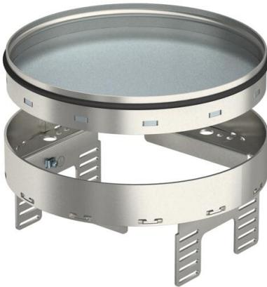
Nivellierbare und vom Fußboden entkoppelte Kassette "blind" für die Herstellung einer Revisionsöffnung der Nenngröße R4 in trocken oder nass gepflegten Fußböden im Innenbereich, zur Montage in Unterflurdosen UZD250-3 oder UZD350-3, jeweils in Verbindung mit einem Montagedeckel DUG..R4 oder in UGD250-3R4 oder UGD350-3R4. Die Montage erfolgt mittels Nivellierwinkel (separat bestellen) im Aluminium-Rahmenprofil der Unterflurdosen. Nur für glatte Bodenbeläge geeignet.
