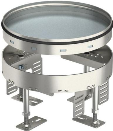
Runde Kassette Schwerlast "blind" in Nenngröße R4 für die Herstellung einer Revisionsöffnung in Kanalsystemen, Doppel- und Hohlböden, in trocken oder nass gepflegten Fußböden im Innenbereich. Belastungsklasse 2 bis 20 kN. Nur für glatte Bodenbeläge geeignet.
