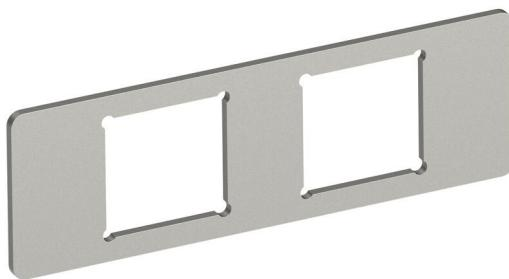
Montageplatte zur Aufnahme von zwei Anschlussbuchsen der Datentechnik folgender Typen: AMP TYCO: Standard 110Connect, SL Serie 110Connect u. Toolless, AMP-Twist ; Brand-Rex: ungeschirmtes Modul; GG45; TKM RJ MOD; Nexans: LANmark Modul mit Adapter-Clip; Siemon CAT6; 3M K6 und K10. Abmessung einer Montageöffnung in mm: 20,10 x 14,80.
