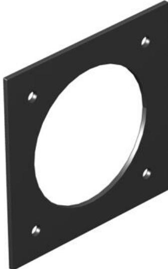
Abdeckplatte mit 1 Lochung ( $\varnothing$  70 mm) und 60 x 60 mm Schraubbefestigung für CEE-Steckdosen, passend zur T4L- und T8NL- Schmalseite oder zur T4L- und T8NL-Längsseite (1/2-Abdeckung).
