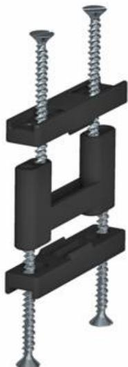
Für Mantelleitungen bis Ø 16 mm, zur Befestigung an der Trennwand. Beim Einsatz in T12L sind maximal 5 Zugentlastungen einsetzbar, bei T4B sind maximal 2 einsetzbar.
