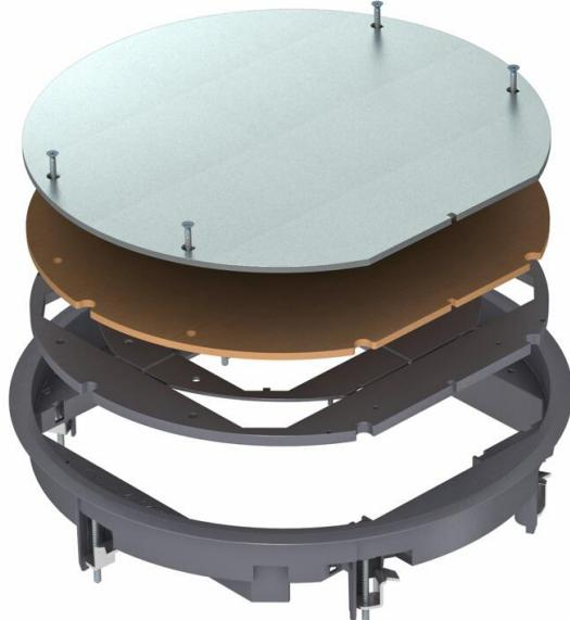
Zugdoseineinsatz zum Blindverschluss einer runden Montageöffnung der Nenngröße R9 in Kanalsystemen sowie in Doppel- und Hohlböden im Innenbereich. Mit Universalbefestigungswinkel. Teppichschutzrahmen aus Polyamid. Bodenbelagstärke max. 12 mm.
