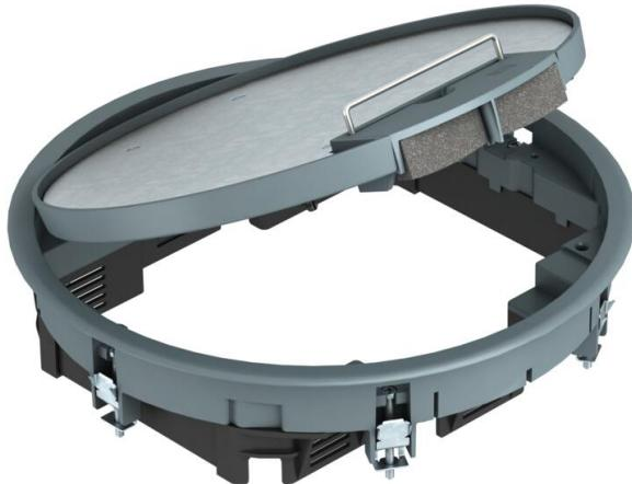
Geräteeinsatz mit Griffbügel für bis zu 10 Modul 45-Einzelgeräte in 2 Universalträger UT3 und einem UT4, Einsatz in Kanalsystemen und Systemböden im Innenbereich.
