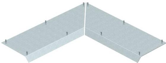
Blinddeckel 2-teilig zum Abdecken des Innenecks eines Aufflurkanals, passend zu den Kanalunterteilen AIK/U inkl. 10 Befestigungsschrauben. Der Kanaldeckel wird in den Al-Seitenprofilen des Kanalunterteils festgeschraubt. Die Deckelschräge überragt das Kanalunterteil im 45°-Winkel.
