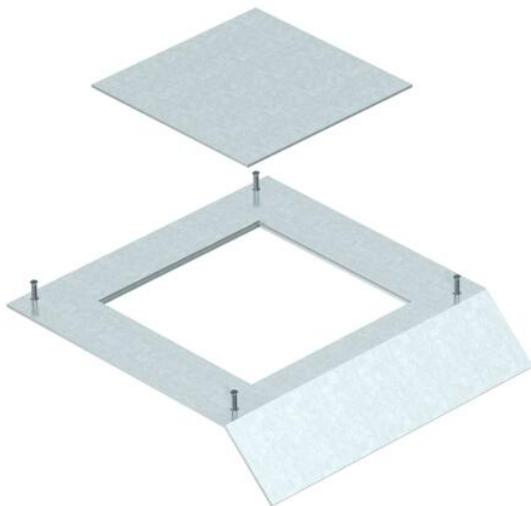
Geräteeinsatzdeckel für Kanalunterteil AIK/U für den Einbau eines Geräteeinsatzes der Nenngroße 9. Montageöffnung durch 2-mm-Alu-Blindplatte verschlossen. Der Kanaldeckel wird in den Al-Seitenprofilen des Kanalunterteils festgeschraubt. Die Deckelschräge überragt das Kanalunterteil im 45°-Winkel.
