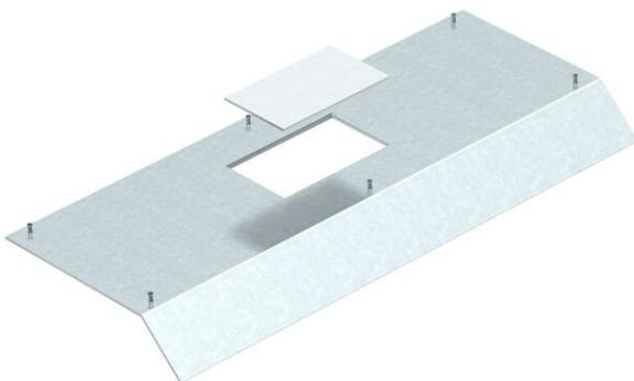
Geräteeinsatzdeckel für Kanalunterteil AIK/U für den Einbau eines Geräteeinsatzes der Nenngroße 2. Montageöffnung durch 2-mm-Alu-Blindplatte verschlossen. Der Kanaldeckel wird in den Al-Seitenprofilen des Kanalunterteils festgeschraubt. Die Deckelschräge überragt das Kanalunterteil im 45°-Winkel.
