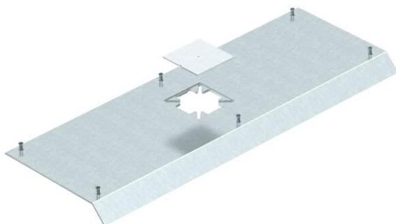
Geräteanschlussdeckel für Kanalunterteil AIK/U für den Aufbau eines Telitanks. Der Kanaldeckel wird in den Al-Seitenprofilen des Kanalunterteils festgeschraubt. Die Deckelschräge überragt das Kanalunterteil im 45°-Winkel.
