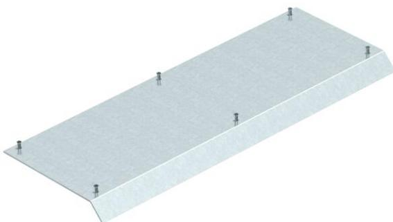
Aufflur-Blinddeckel zum Abdecken des Aufboden-Installationskanals AIK, passend zu den Kanalunterteilen AIK/U. Der Kanaldeckel wird in den Al-Seitenprofilen des Kanalunterteils festgeschraubt. Die Deckelschräge überragt das Kanalunterteil im 45°-Winkel.
