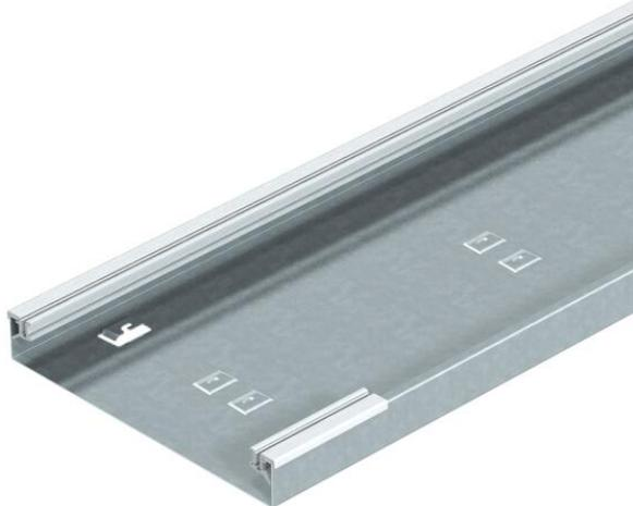
Abzweig-Aufflur-Installationskanal-Unterteil für Blind-/Montagedeckel mit beidseitiger Abschrägung, zur Montage frei auf dem Fußboden, mit aufsteckbaren Aluminium-Seitenprofilen zum Auflagern und Befestigen der Kanaldeckel. Kanalhöhe geeignet zum Aufbau von Telitanks.
