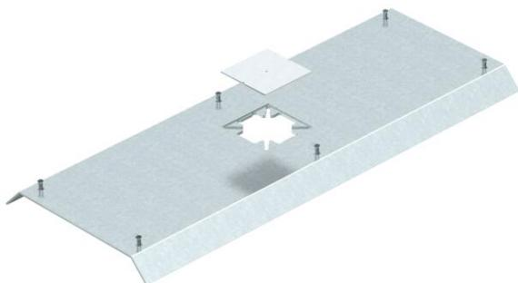
Geräteanschlussdeckel für Abzweigkanalunterteil AIKA/U für den Aufbau eines Telitanks. Der Kanaldeckel wird in den Al-Seitenprofilen des Kanalunterteils festgeschraubt. Die Deckelschräge überragt das Kanalunterteil beidseitig im 45°-Winkel.
