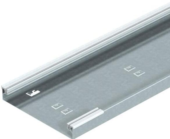
Aufflur-Installationskanal-Unterteil, 1-zügig, für Blind-/Montagedeckel mit einseitiger Abschrägung, mit aufsteckbaren Aluminium-Seitenprofilen zum Auflagern und Befestigen der Kanaldeckel, Bodenwanne mit Halteschellen für max. 2 einsteckbare, selbstkontakterende Trennstegs und Prägung für Schutzleiteranschlusswinkel. Kanalhöhe geeignet zum Einbau von Geräteeinsätzen der Nenngröße 2.
