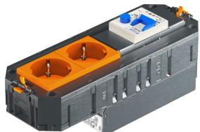
Anschlussfertiger Universalträger Connect UTC4 mit WAGO Steckverbinderystem WINSTA® MIDI. Passend zu den Verbindungsleitungen VL-WIN und für den Einsatz in den Geräteeinbaeinheiten der Nenngröße R7, 9 und R9. Der anschlussfertige Universalträger UTC4 FI verfügt über 2, mit FI/LS abgesicherte, Schutzkontakt-Steckdosen. Interne Verdrahtung mit 2,5 mm<sup>2</sup>. Bitte beachten Sie die Anschlussbedingungen (und auch die Selektivität)!
