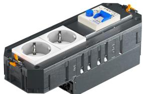
Anschlussfertiger Universalträger Connect UTC4 mit WAGO Steckverbinder-System WINSTA® MIDI. Passend zu den Verbindungsleitungen VL-WIN und für den Einsatz in den Geräteeinbaeinheiten der Nenngröße R7, 9 und R9. Der anschlussfertige Universalträger UTC4 FI verfügt über 2, mit FI/LS abgesicherte, Schutzkontakt-Steckdosen. Interne Verdrahtung mit 2,5 mm<sup>2</sup>. Bitte beachten Sie die Anschlussbedingungen (und auch die Selektivität)!
