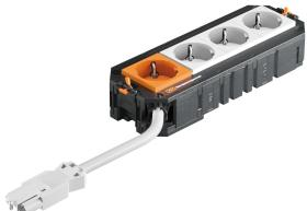
Anschlussfertiger Universalträger UTC4 mit halogenfreier Anschlussleitung. Er verfügt über drei vorinstallierte 33° Schutzkontakt-Steckdosen in weiß und eine 33° Schutzkontakt-Steckdose in reinorange mit 16 A. Die Schutzkontakt-Steckdose in reinorange ist durch ein Überspannungsschutz-Modul Typ 3 nach DIN EN 61643-11 gesichert. Passend zu den Verbindungsleitungen VL und den Geräteeinbaeinheiten der Nenngröße R7, R9 und 9.
