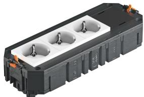
Der anschlussfertige Universalträger UTC4 verfügt über drei vorinstallierte 33° Schutzkontakt-Steckdosen mit 16 A und eine Blindabdeckung für den nachträglichen Einbau von einem Installationsgerät der Serie Modul 45 oder Modul 45connect. Passend zu den Verbindungsleitungen VL und den Geräteeinbaueinheiten der Nenngröße R7, R9 und 9.
