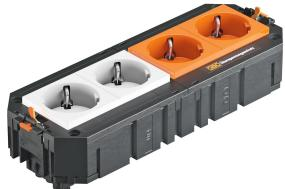
Der anschlussfertige Universalträger UTC4 verfügt über zwei vorinstallierte 33° Schutzkontakt-Steckdosen in reinweiß und zwei vorinstallierte 33° Schutzkontakt-Steckdosen in reinorange mit 16 A. Passend zu den Verbindungsleitungen VL und den Geräteeinbaeinheiten der Nenngröße R7, R9 und 9. Die Schutzkontakt-Steckdosen in reinorange sind durch ein Überspannungsschutz-Modul Typ 3 nach DIN EN 61643-11 gesichert.
